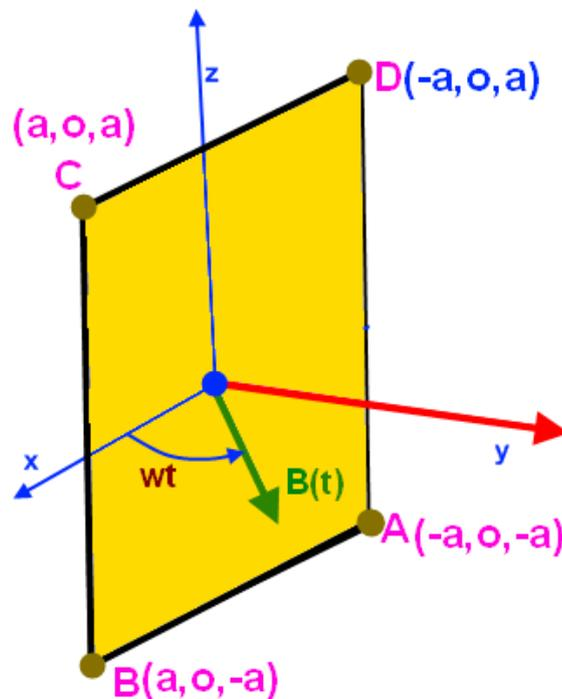
Figure 2: une spire fixe dans un champ magnétique variant dans le temps
