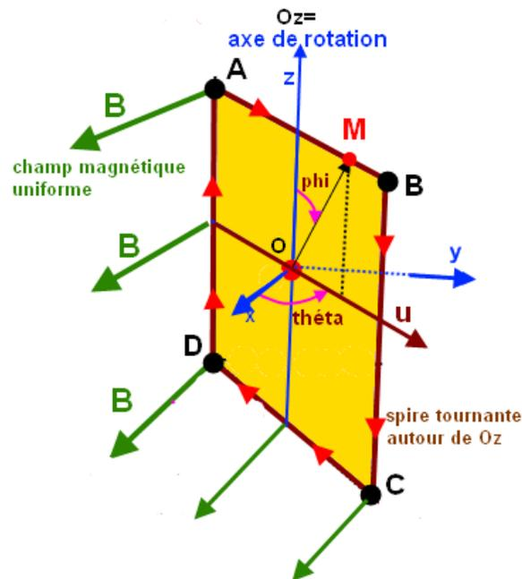
Figure 3: Spire ABCD de centre O tournante dans un champ  $\vec{B}$  uniforme parallèle à  $\overrightarrow{Ox}$ . L'axe de rotation est  $\overrightarrow{Oz}$ .
